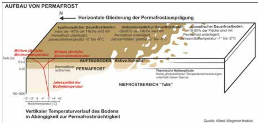
Рис. 1. Основная структура вечномерзлого грунта.
