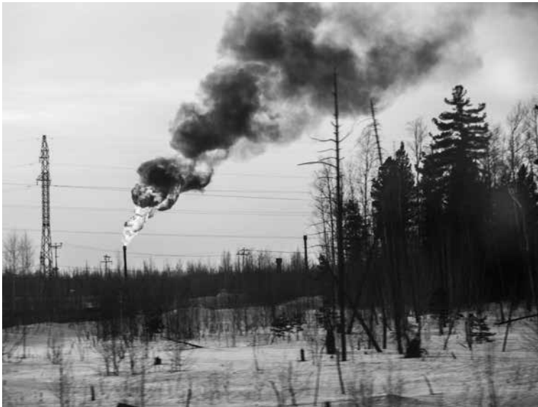
Abb. 8: Abbrennen von Begleitgas auf einem Erdölfeld.
